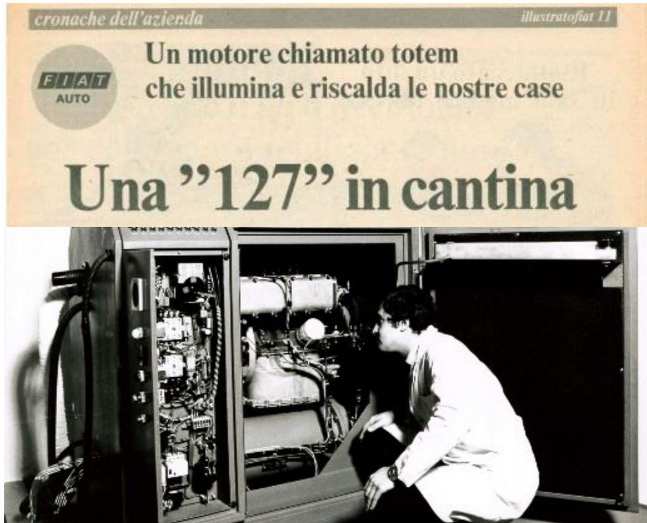
Il TOTEM (acronimo di TOTAl Energy Module), nato nel 1977 al Centro Ricerche Fiat, è stato il primo microcogeneratore ad essere brevettato e prodotto. Utilizzava un motore da 903 cc alimentato a gas naturale, o a biogas, per far girare un alternatore che sviluppava 15 kWe. Recuperando il calore dei gas di scarico e quello sviluppato dal motore, il primo TOTEM erogava inoltre 33.500 kcal.
